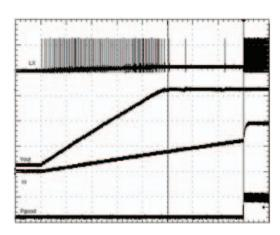
Fig. 31 - Soft-Start Timing Diagram
