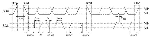
Fig4 I<sup>2</sup>C timing parameters
