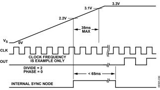
Figure 18. Power-On Sync Timing
