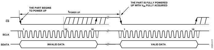
Figure 18. Exiting Power-Down Mode
