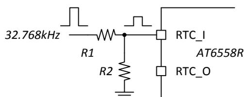
图 8.3 32k 直接时钟输入（电阻分压）
