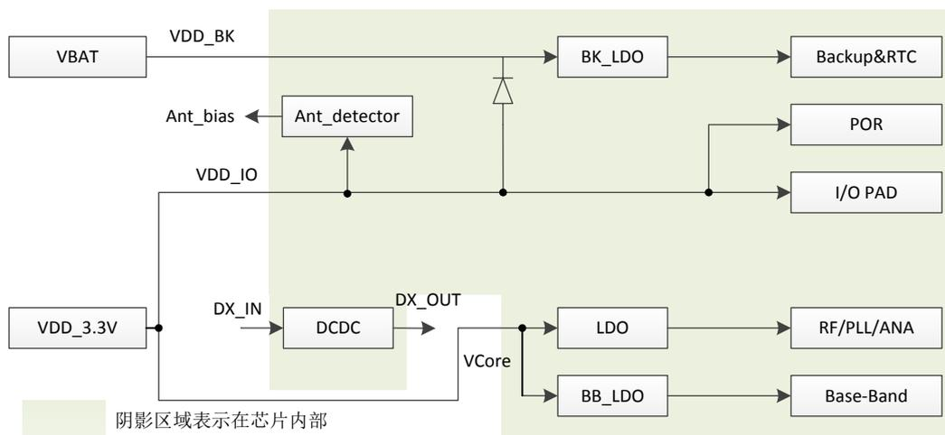
图 3-3 不用芯片内部 DCDC 的电源连接方案
