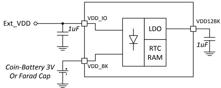
图 8.4 备份电源连接方案图
