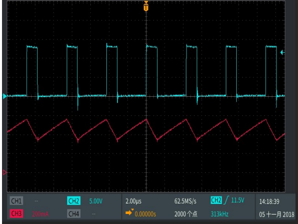
SW 脚与电感电流工作波形
