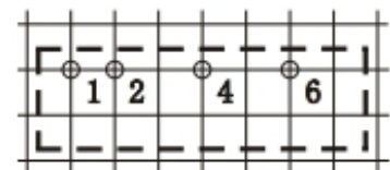
俯視圖, 柵格間距 2.54mm 開孔直徑 1.00mm
