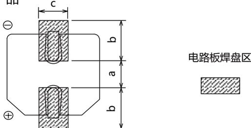
(推荐电路板焊盘尺寸)
