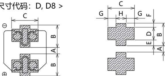
(推荐电路板焊盘尺寸)
