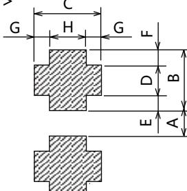
(推荐电路板焊盘尺寸)
