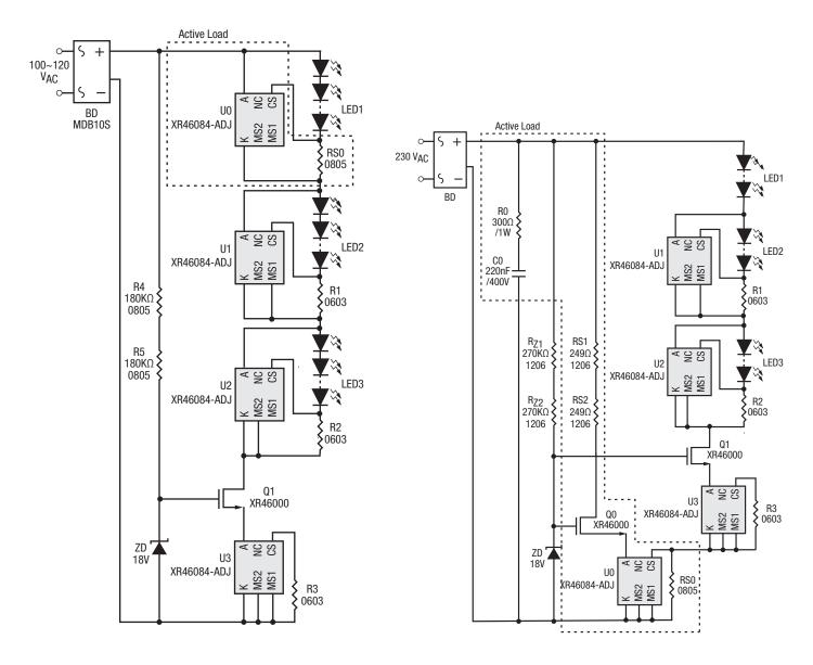
Figure 12. 120 V<sub>AC</sub> TRIAC Dimmable 3-Step Solution
