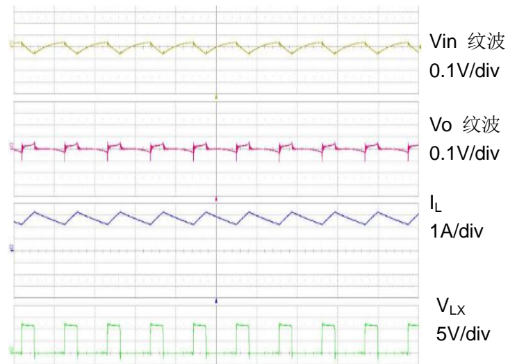
Fig.5 满载工作 2μs/div
