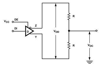
FIGURE 1. DRIVER  $V_{\mbox{\scriptsize OD}}$  and  $V_{\mbox{\scriptsize OC}}$
