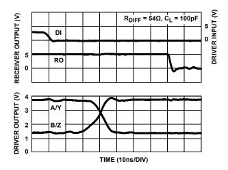
FIGURE 13. DRIVER AND RECEIVER WAVEFORMS, HIGH TO LOW
