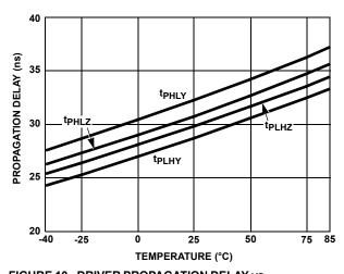
FIGURE 10. DRIVER PROPAGATION DELAY vs TEMPERATURE
