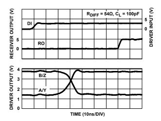
FIGURE 12. DRIVER AND RECEIVER WAVEFORMS, LOW TO HIGH
