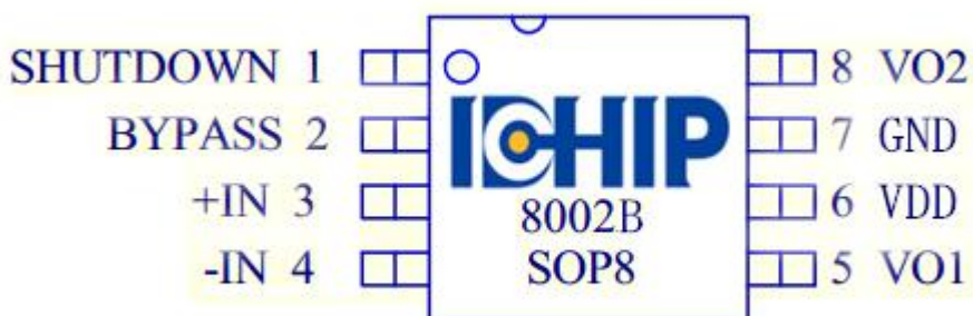
图 2. SOP-8 封装管脚分布图
