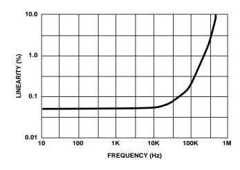
FIGURE 18. TRIANGLE WAVE LINEARITY vs FREQUENCY
