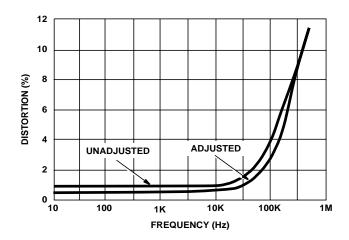
FIGURE 20. SINE WAVE DISTORTION vs FREQUENCY
