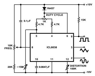
FIGURE 8. VARIABLE AUDIO OSCILLATOR, 20Hz TO 20kHzY
