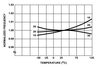
FIGURE 13. FREQUENCY vs TEMPERATURE
