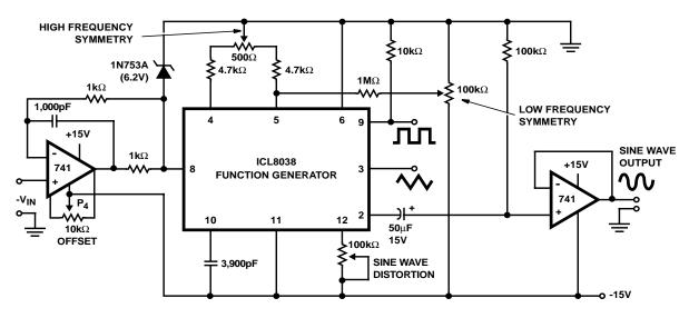
FIGURE 10. LINEAR VOLTAGE CONTROLLED OSCILLATOR
