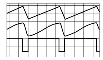
FIGURE 2B. SQUARE WAVE DUTY CYCLE - 80%
