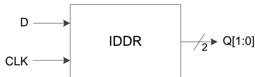
图 3-15 I/O 逻辑的 DDR 输入示意图
