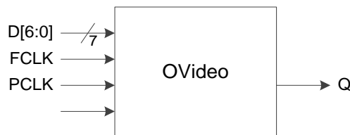
图 3-20 I/O 逻辑的 OVideo 输出示意图
