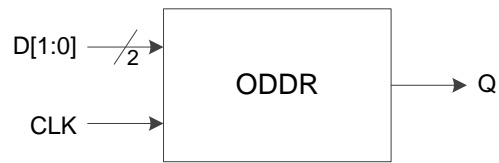
图 3-16 I/O 逻辑的 DDR 输出示意图
