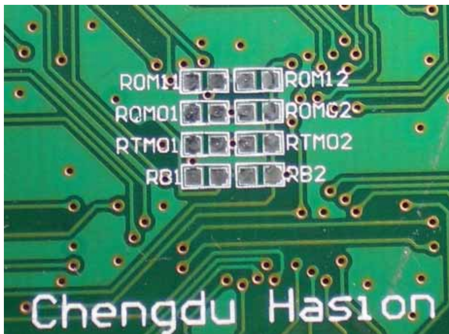
图 3 HS-NM5300A 背面跳线
