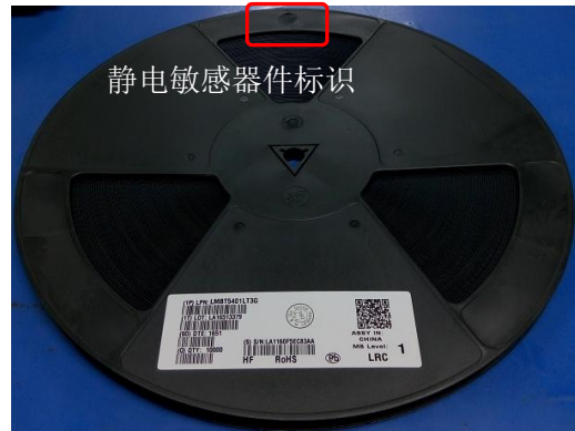
13英寸卷盘标签张贴及QA印章位置
