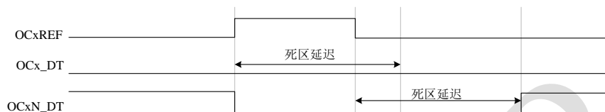
Figure 106 死区时间大于 OCxREF 无效电平宽度时的死区插入
