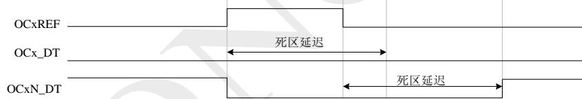
Figure 98 死区时间大于 OCxREF 有效电平宽度时的死区插入
