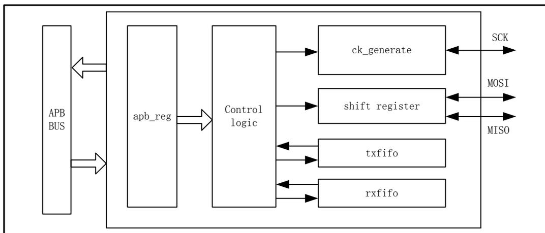
图 6-22 SPI 控制器结构示意图
