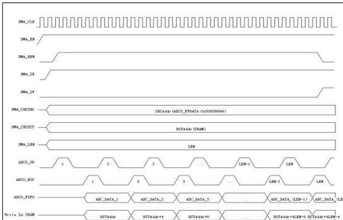
图 6-45 SAR ADC 中 FFDATA 内数据写入到内存
