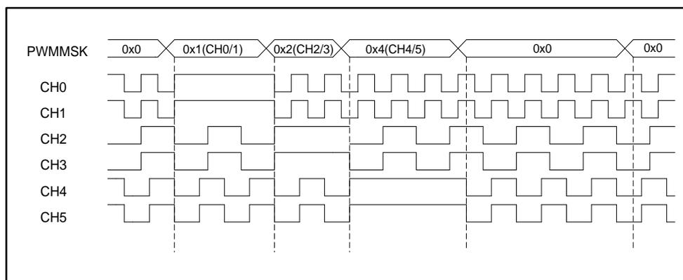
图 6-42 输出屏蔽功能示意图
