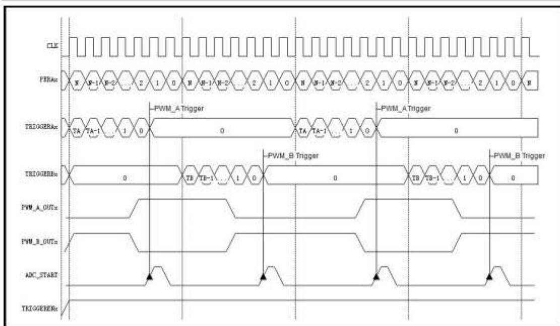
图 6-37 PWM 触发 ADC 采样示意图
