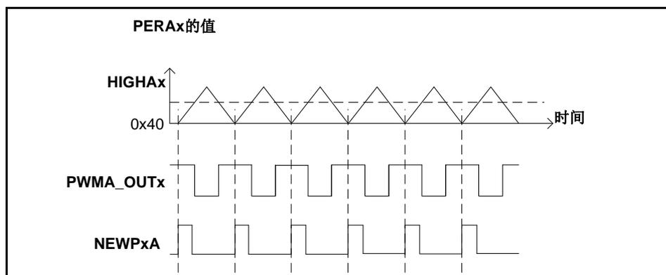
图 6-40 PWM 中心对称模式下新周期起始中断示意图
