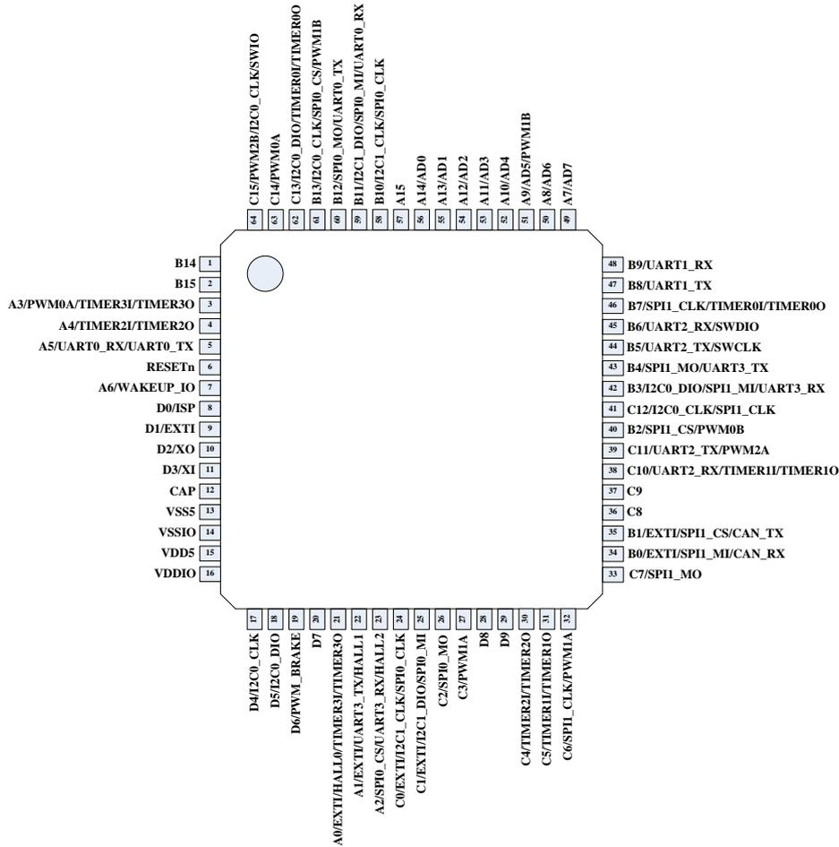
图 5-4 SWM220R8T7 封装管脚配置
