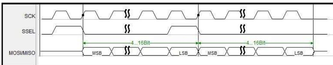
图 6-28 SSI 模式连续输出波形
