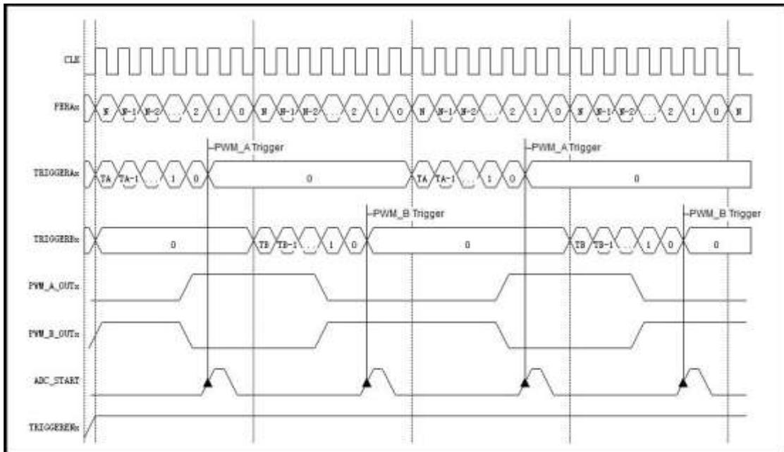
图 6-43 触发 ADC 采样示意图
