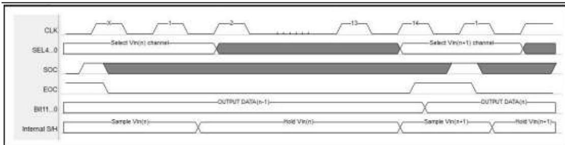
图 6-44 SAR ADC 连续采样示意图
