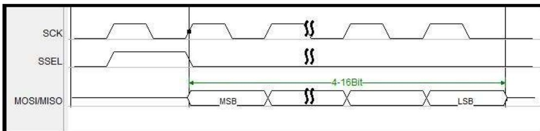
图 6-27 SSI 模式单次输出波形
