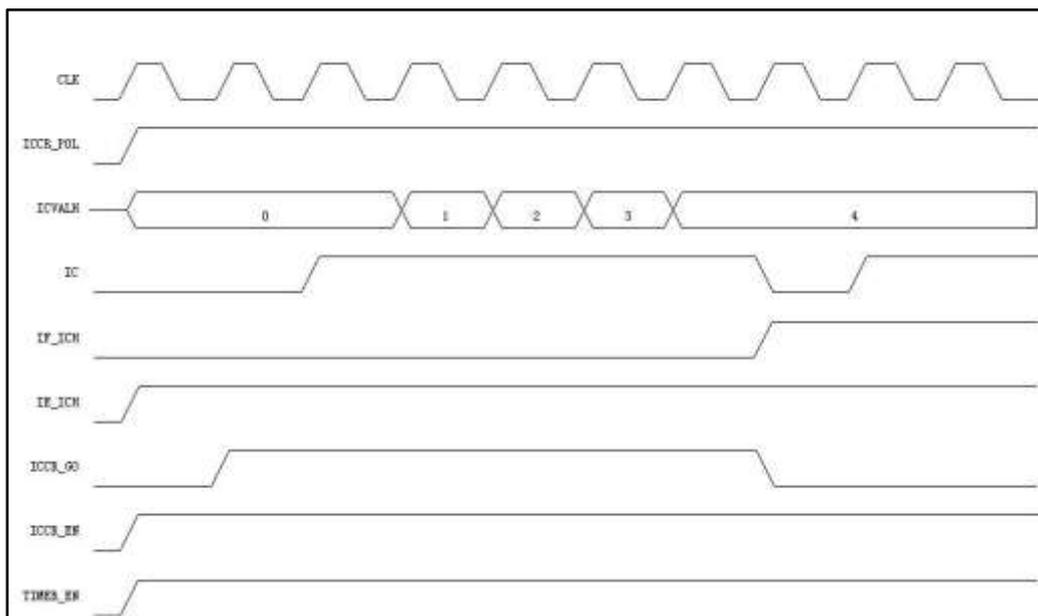
图 6-9 单次捕捉高电平脉冲
