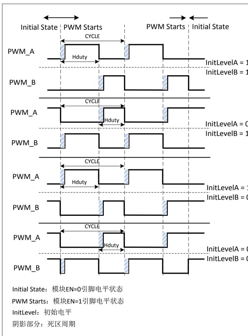
图 6-30 互补模式下初始电平设置示意图
