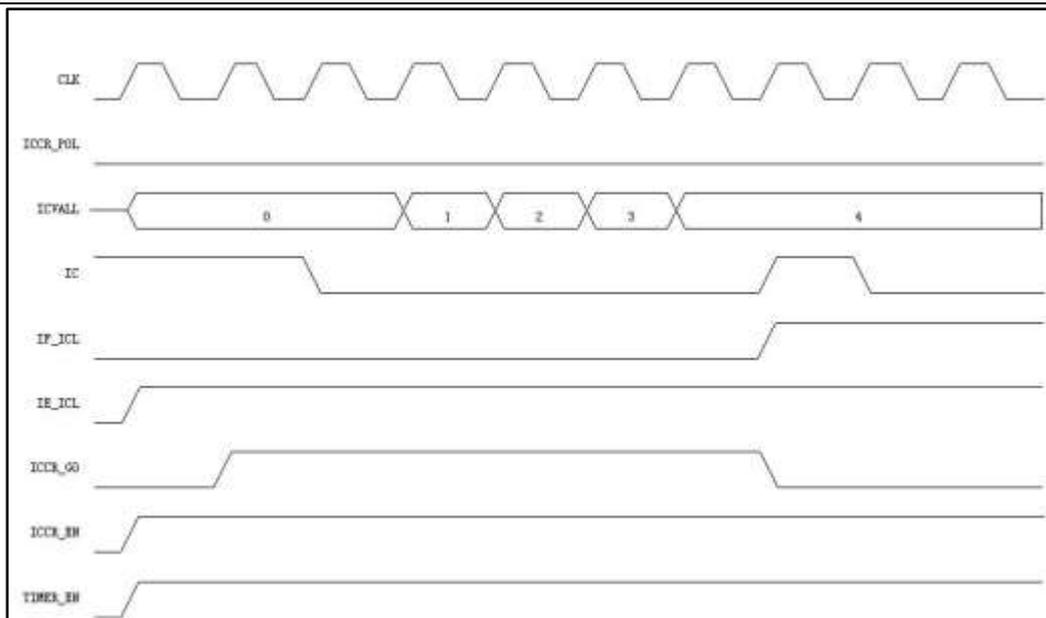
图 6-10 单次捕捉低电平脉冲
