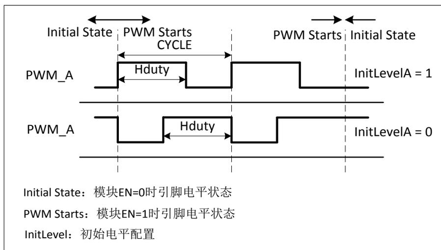
图 6-29 独立模式下初始电平配置示意图
