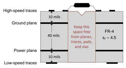
图 45. Recommended Layer Stack
