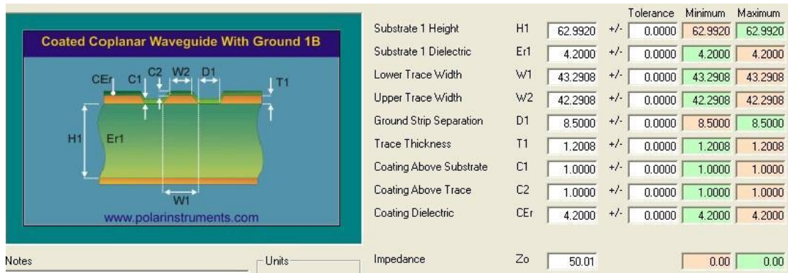
图 7: 50Ω 阻抗的理论计算示意图
