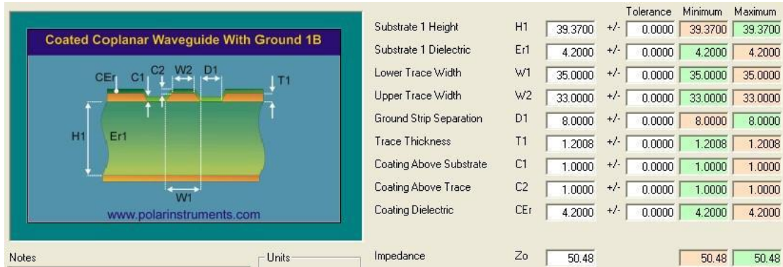
图 9： 50Ω 阻抗的理论计算示图
