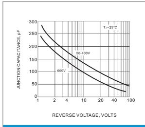
Fig.2 TYPICAL JUNCTION CAPACITANCES
