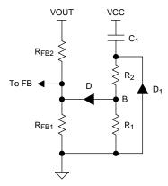
Figure 12. Soft-Start Circuit
