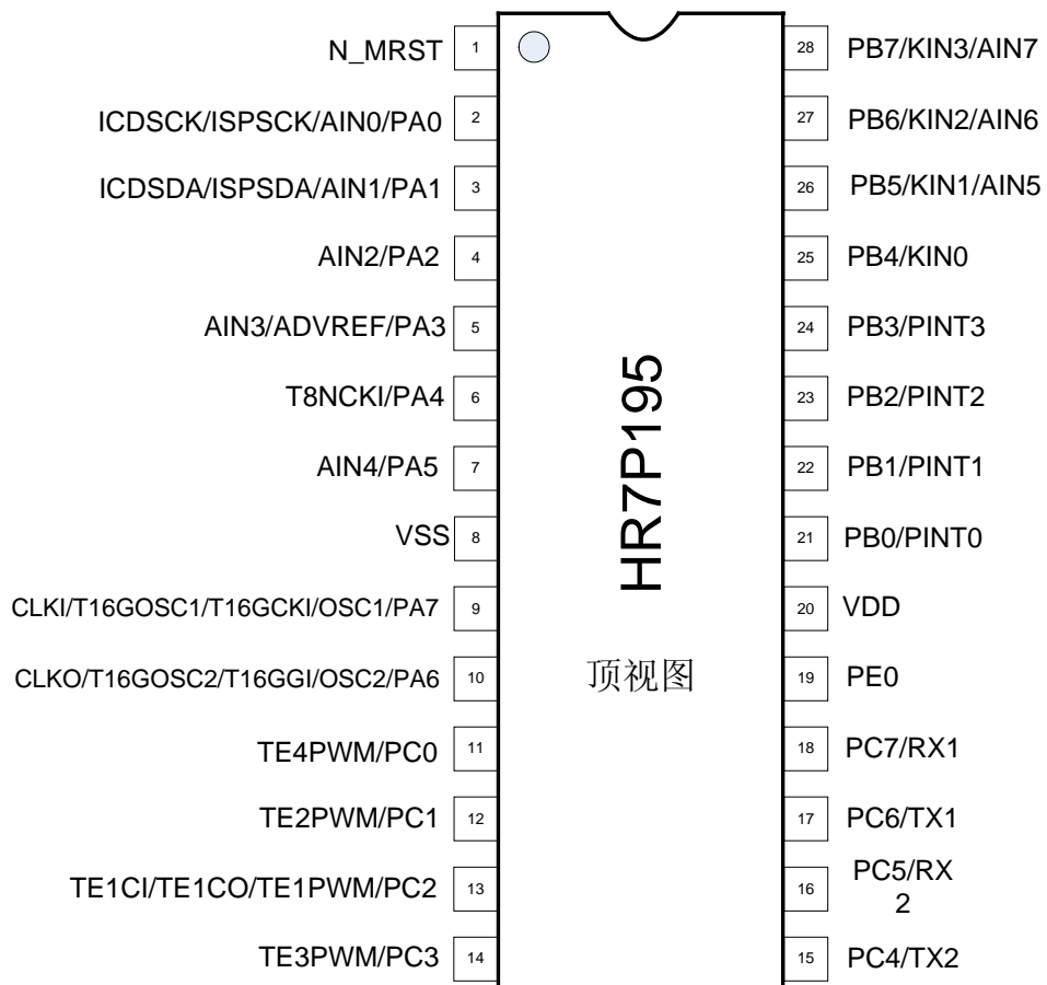
图 1-3 HR7P195 芯片 28pin 顶视图
