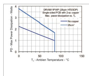
Figure 15. Power Dissipation (2-Layer)
