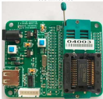
SOP-28转换座的安装
