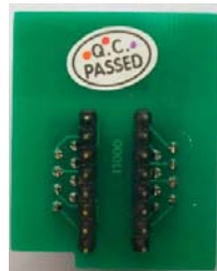
SOP-16和SOP-8的转换座(反面)
