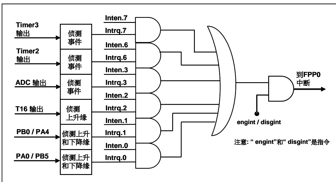
图 8: 中断硬件框图
