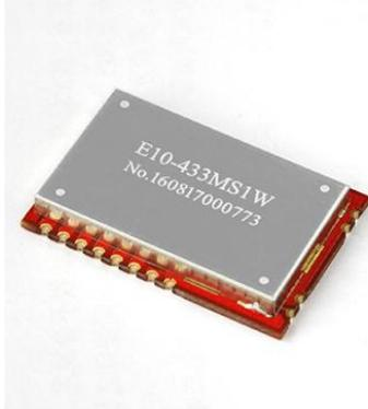
E10-433MS1W 是成都亿佰特公司一款上市多年且小有名气的 SI4463 射频模块，频率 433M，发射功率 1W，SPI 接口，小体积贴片型，采用 26M 晶振，带有 LNA 低噪声放大器，从而提高接收灵敏度。目前已经稳定量产，已经大量应用于智能锁等领域。
