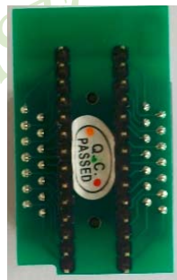
SOP-28和SOP-20的转换座(反面)
