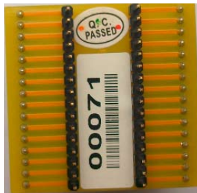
SOP-32的转换座(反面)
