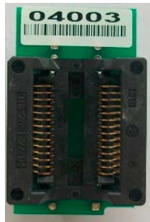
SOP-28和SOP-20的转换座(正面)
