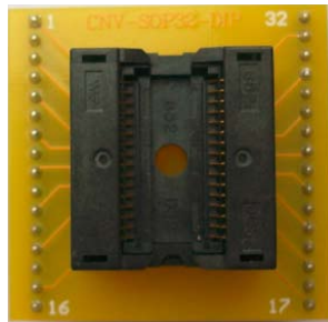
SOP-32的转换座(正面)
