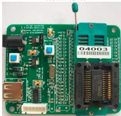
SOP-28转换座的安装
