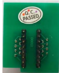
SOP-16和SOP-8的转换座(反面)
