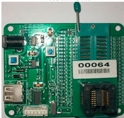
SOP-16转换座的安装
