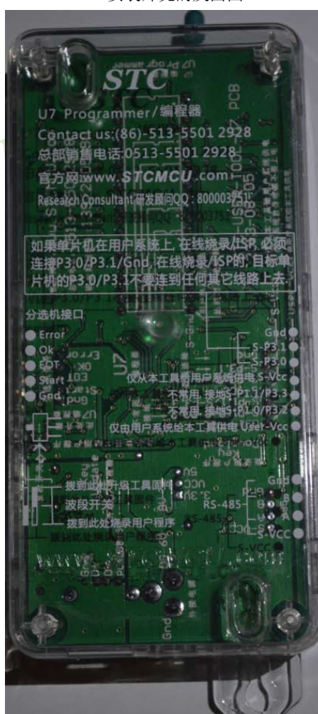
U7安装外壳的反面图
