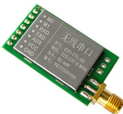
E51-TTL-50 是一款 230M 直插型无线串口模块 (UART)，半双工，收发一体，透明传输方式，发射功率 50mW，工作在 225~237.6MHz 电力频段（默认 230MHz），TTL 电平输出，兼容 3.3V 与 5V 的 IO 口电压，具有空中唤醒功能（超低功耗）。
