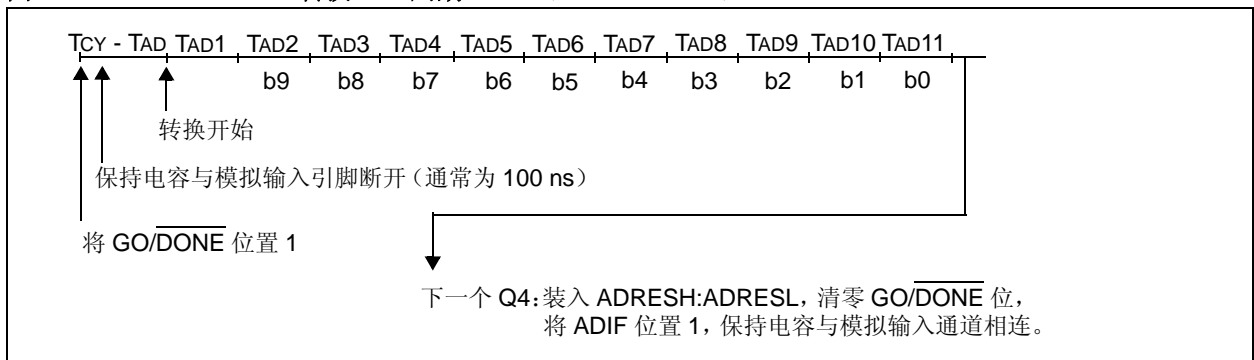
图 21-3: A/D 转换 TAD 周期 ( \text{ACQT}<2:0> = 000 , \text{TACQ} = 0 )
