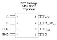
DCU Package 8-Pin VSSOP Top View A 8 1 2 7 В 🖂 □ R<sub>ext</sub>/C<sub>ext</sub> CLR 💷 C<sub>ext</sub> 3 6 5 ΠQ GND 🗌 4
