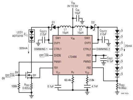
$c_{IN}\!\!:$  6.3V, X5R OR X7R DIELECTRIC  $c_{OUT1}\!\!,$   $c_{OUT2}\!\!:$  35V, X5R OR X7R D1: ZETEX ZHCS1000
