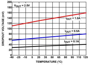
FIGURE 3. DROPOUT VOLTAGE vs TEMPERATURE
