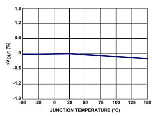
FIGURE 4. V<sub>OUT</sub> vs TEMPERATURE
