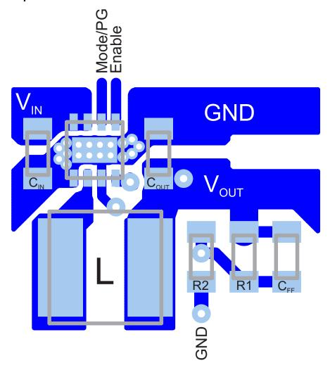
Figure 28. PCB Layout
