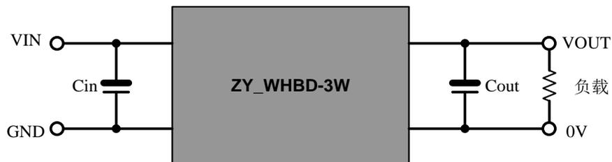
图 5.1 ZY\_WHBD-3W 电源模块工作电路连接
