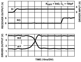
FIGURE 16. DRIVER AND RECEIVER WAVEFORMS, LOW TO HIGH (ISL8485E)
