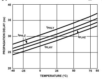
FIGURE 12. DRIVER PROPAGATION DELAY vs TEMPERATURE (ISL8485E)
