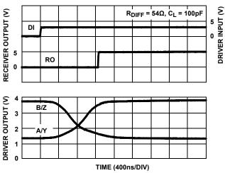
FIGURE 14. DRIVER AND RECEIVER WAVEFORMS, LOW TO HIGH (ISL8483E)
