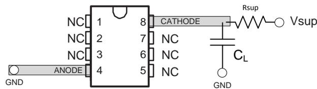
**Figure 12. Layout Diagram**
